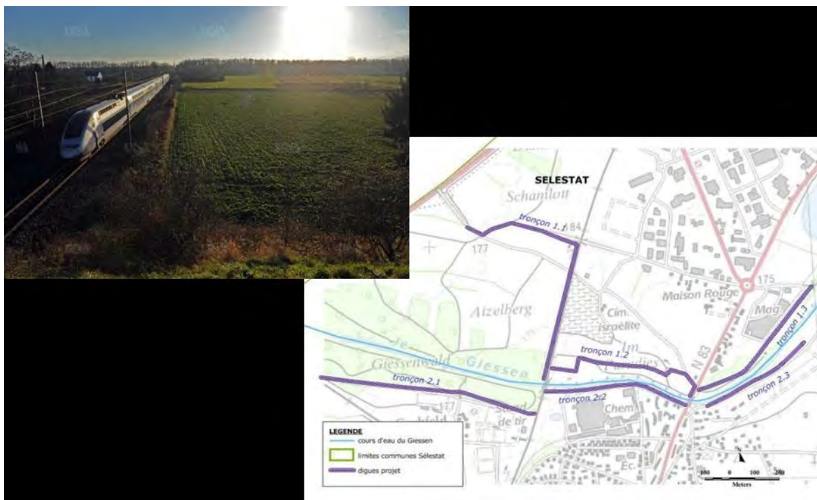
Figure 6 : Travaux de construction de digues prévus dans le cadre du PAPI du Giessen, avec création d'une zone de stockage derrière la voie ferrée, sur des terres agricoles.
