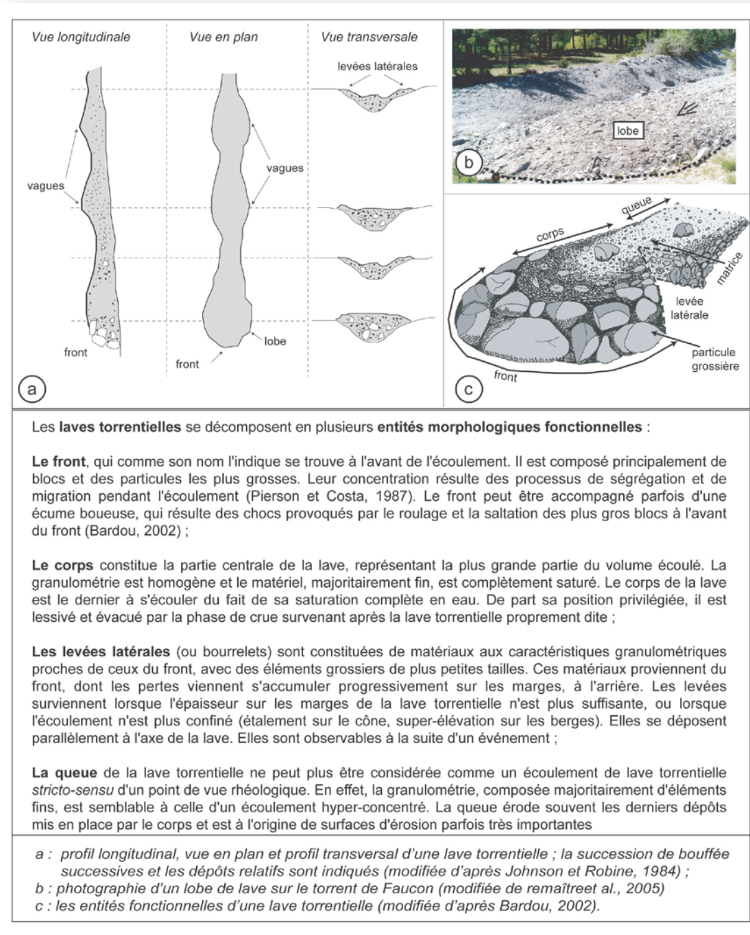
Figure A2 - Morphologie et entités fonctionnelles d'une lave torrentielle (Remaître, 2006)
