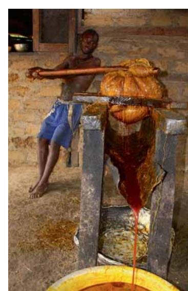
Extraction artisanale de l'huile de palme à la « chaussette », environs de Kribi, Sud Cameroun.
